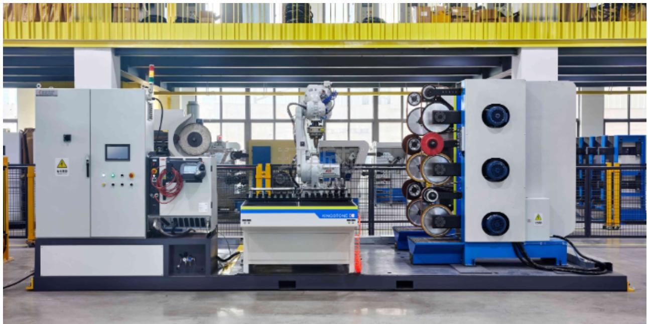
轨道打磨加工流水线，包括柔性打磨机器人与轨道检测夹具，轨道检测夹具上设有焊缝检测机构与轨道夹持机构，柔性打磨机器人包括有工业机器人以及柔性打磨装置，柔性打磨装置包括连接头、驱动电机、活动支架、砂带轮组件以及设置在砂带轮组件与传动轮，驱动电机的输出端穿过活动支架后设置驱动轮，并通过驱动轮带动传动轮驱动两端的砂带轮组件运作，连接头设有柔性打磨空间，活动支架通过驱动电机固定在柔性打磨空间内，并在柔性打磨空间内以驱动电机为支点左右摆动，轨道检测夹具通过焊缝检测机构检测到焊缝后通过轨道夹持机构将带有焊缝的轨道停留在柔性打磨机器人的打磨区域内。
