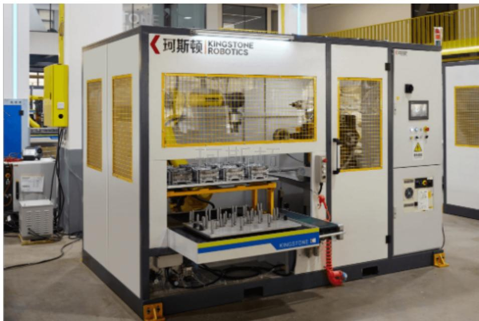
自动化机器人抛光系统可以确保产品打磨出来的一致性和精确性，避免出现传统工艺中由人工抛光不精确、不匀称等原因造成的产品浪费。特别是机器人柔性抛光技术发展成熟，应用于不锈钢抛光打磨，弥补了传统抛光设备无法满足小批量、工艺要求复杂、工件型面复杂等抛光工作的不足。机器人利用伺服电机多关节模仿人的手臂关节动作，实现操作抛光打磨任务。机器人可以对不同的工件进行抛光打磨，既可以对工件进行整体打磨也可以进行局部的打磨。整个工作过程机器人可以自动完成，您只需要按一下开机按钮即可。目前，机器人抛光在不锈钢行业发挥着重要的作用。机器人抛光，就选浙江珂斯顿机器人科技有限公司，让您满意，欢迎您的来电！山西罐体机器人抛光打磨
